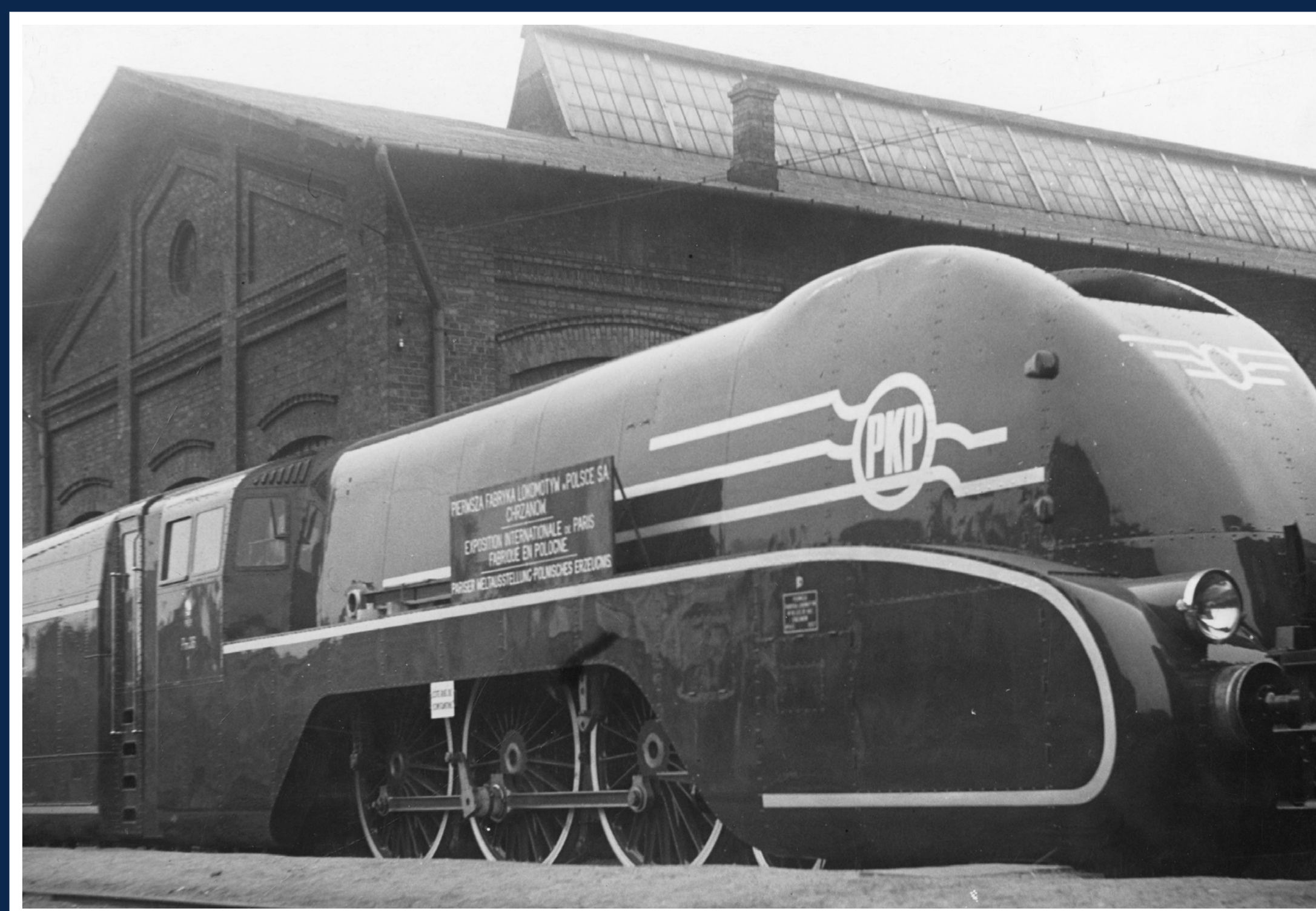
Parowóz pośpieszny Pm36 z otuliną aerodynamiczną, 1937, fot. Narodowe Archiwum Cyfrowe
